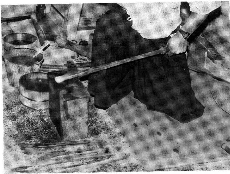
テコ棒の先端部を赤めて整える。
