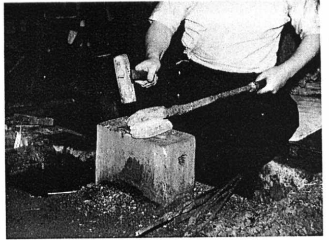
② 小槌を使ってさらに打ち曲げる。
